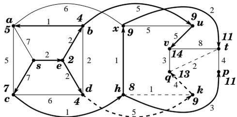
Ovviamente ogni arco del grafo non contenuto nell'albero dei cammini minimi (ossia ogni arco in linea non spessa) può essere rimosso senza allontanare alcun nodo dal nodo  $s$ . Inoltre, anche i due archi in linea spessa ma tratteggiata possono essere rimossi poichè sostituibili con altri archi (sempre in linea tratteggiata).
