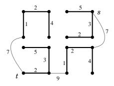
Nella seguente figura vengono riportati tutti e soli quegli archi del grafo originario che appartengono ad un qualche albero ricoprente di peso minimo. Gli archi contenuti in ogni soluzione ottima sono ancora rappresentati tramite linee molto spesse. Il peso complessivo degli archi contenuti in ogni soluzione ottima ammonta a 30.
