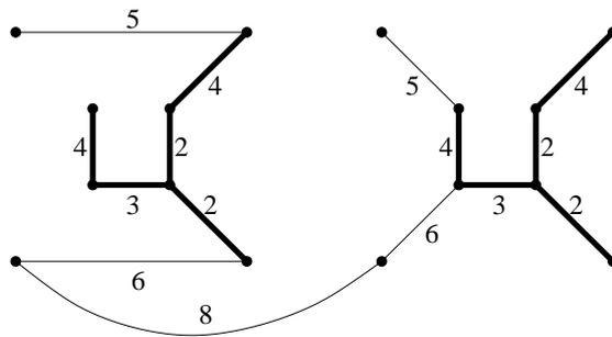
Nella seguente figura vengono riportati tutti e soli quegli archi del grafo originario che appartengono ad un qualche albero ricoprente di peso minimo. In tale figura, gli archi contenuti in ogni soluzione ottima sono rappresentati tramite linee molto spesse. Il peso complessivo degli archi contenuti in ogni soluzione ottima ammonta a 30.
