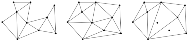
Figura: A sinistra: triangolazione di un poligono qualsiasi. Al centro: triangolazione di un insieme di punti. A destra: triangolazione non valida.
